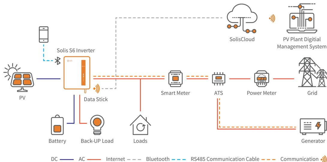
[Légende: Onduleur hybride Solis S6 ; Solis Cloud ; Système de gestion numérique d'installations photovoltaïques ; PV ; Clé de données (contact avec Solis Cloud) ; Compteur intelligent ; ATS ; Compteur électrique ; Réseau ; Batterie ; Charge de secours (lumières, ordinateurs, etc.) ; Charge sur le réseau (réfrigérateur, chauffe-eau, etc.) ; Générateur]
