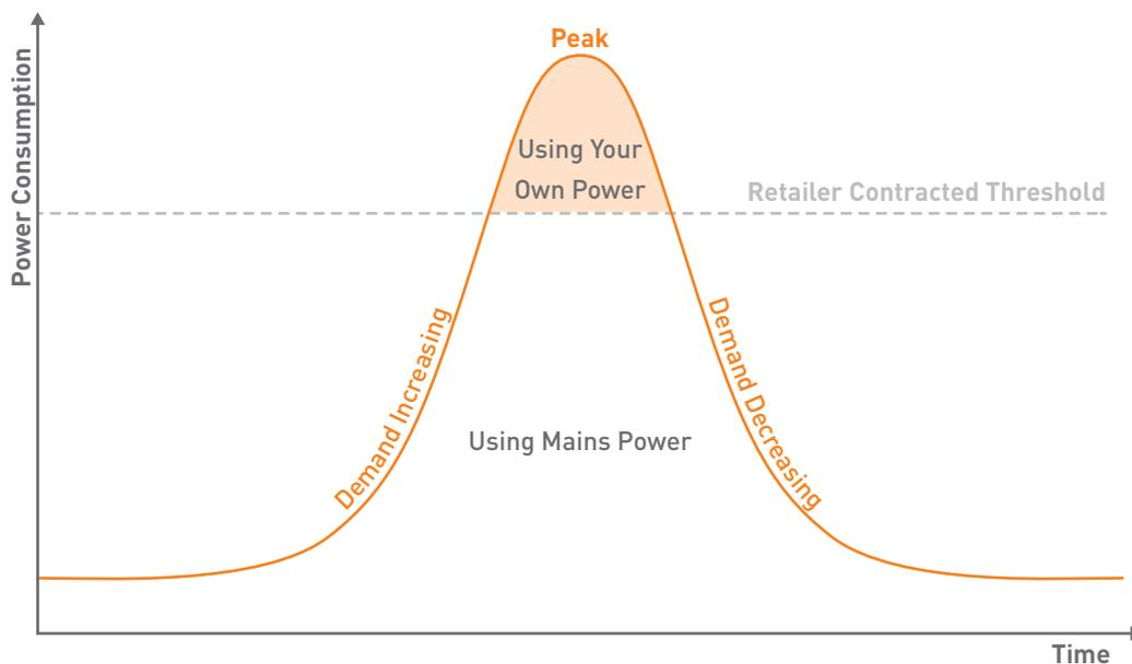
[Légende : Consommation électrique ; Le détaillant a passé un contrat avec l'entreprise ; Pic ; Demande en hausse ; Demande en baisse ; Utilisation de votre propre puissance ; Utilisation de l'énergie du réseau ; Temps]
