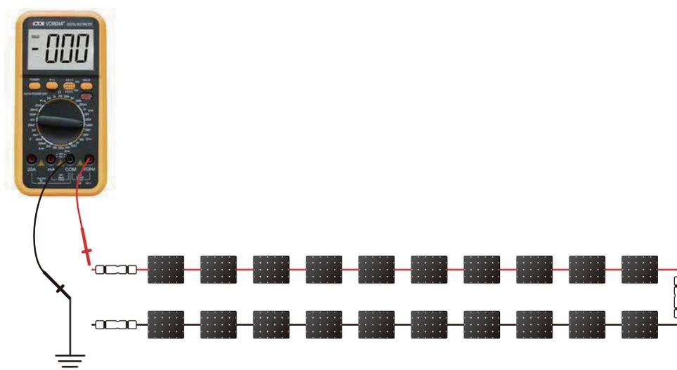
Se a tensão da string do terminal FV+/FV- para o terra estiver desequilibrada, pode ser determinado que a string FV tem uma falha de aterramento. Por exemplo, a tensão de uma polaridade para o terra é 0V ou próxima de 0V, e a outra polaridade para a tensão do terra excede 600V sem qualquer alteração no valor.
