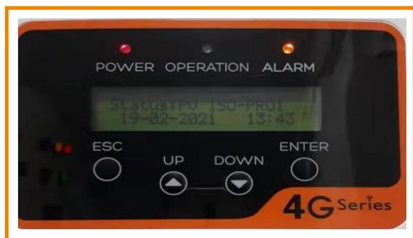
Abbildung 5: Das PV-System hat ein Problem mit niedriger Impedanz
